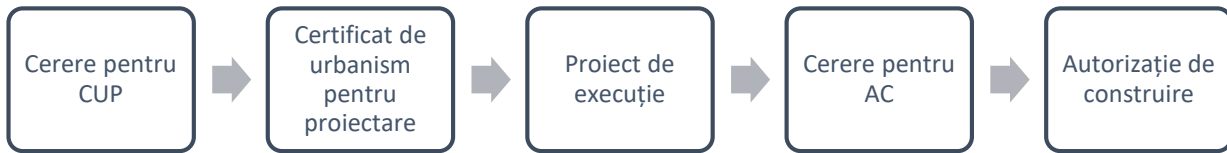
Figura 3. Procedura de eliberare a documentelor permise în construcție. Conform LP163 din 2010 privind autorizarea executării lucrărilor de construcție
